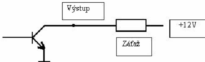
Výstupné svorky L- a L+ sú výstupy galvanicky oddeleného spínacieho tranzistoru. Tento spínač je pri správnej činnosti zopnutý, pri chybe na senzore alebo prekročení nastavenej úrovne II. je rozopnuty. Na funkciu tohto výstupu pri prekročení koncentrácie II. úrovne nemajú vplyv prepojky M a D. Spínací tranzistor je galvanicky oddelený a je možné sériovo radiť viacej výstupov od ďalších detektorov. Pri zapojovaní výstupu je potrebné dbať na polaritu signálu.
